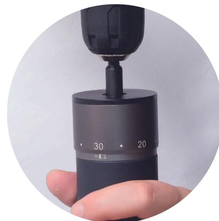
Assicurarsi che il portabit sia completamente inserito nell'albero centrale, afferrare saldamente il mulino e applicare gradualmente la potenza.
